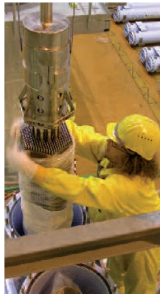
Palivové soubory musejí v reaktoru vydržet teplotu kolem 300 °C a tlak přes 12 MPa.
