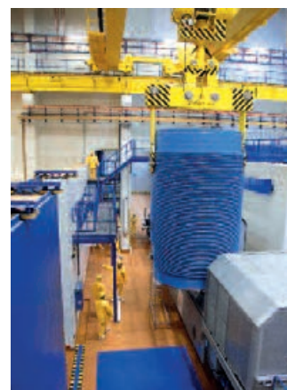
Skladovací a přepravní kontejnery Castor při manipulaci v meziskladech, které jsou umístěny přímo v areálech našich jaderných elektráren.
