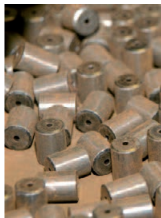
Palivové pelety. V temelínském reaktoru jich je přes 18 miliónů.
